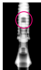
Pilier non indexé, vissage du pilier alors que le pilier n'est pas parfaitement inséré dans l'hexagone de la connexion implantaïre.
